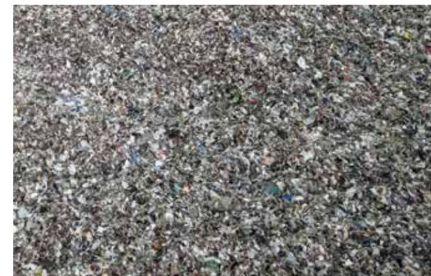
Output zur Verwendung als mittelkalorische Ersatzbrennstoffe
